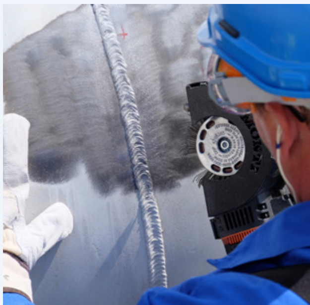
Bild 2: Der Bristle Blaster® erzielt einen Reinheitsgrad vergleichbar mit Sa 2 ½ sowie ein raues Oberflächenprofil
